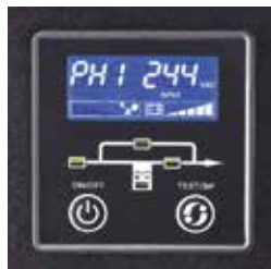
Display de LCD para fácil visualização do status do no-break.
